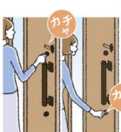
上下のサムターンを 回して解錠
